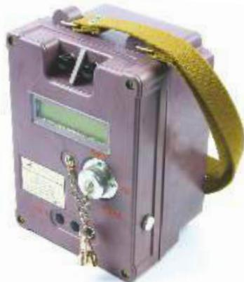
Питание прибора от находящейся внутри аккумуляторной батареи TD-2,4 с номинальным напряжением 12 В и емкостью 2,3 Ач.
