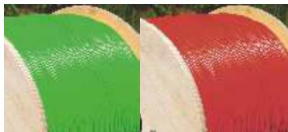
УВТ изготавливается на автоматизированной линии методом экструзии и состоит из трех слоев пластических масс, выдерживающих высокие механические и тепловые нагрузки, устойчивых к воздействию агрессивных сред. На внутренний слой УВТ нанесено взрывчатое вещество, которое после инициирования развивает устойчивый взрывной процесс, распространяющийся внутри трубы со скоростью около 2000 м/с.
